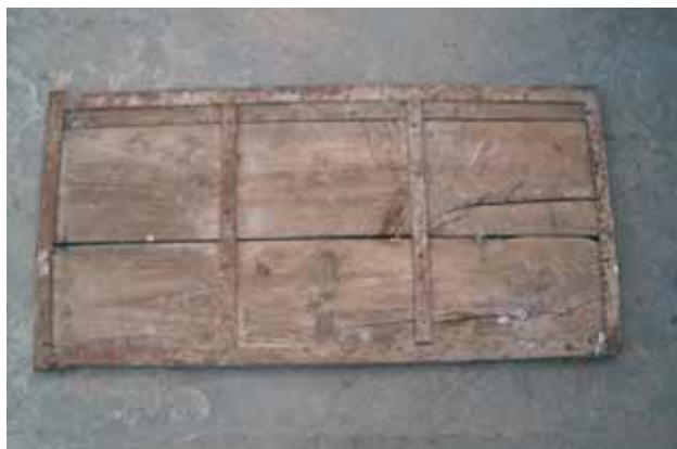
16.2 y 16.3 Las dos caras de la frontera del tapial de Pascual Calero, (Villarrobledo)
