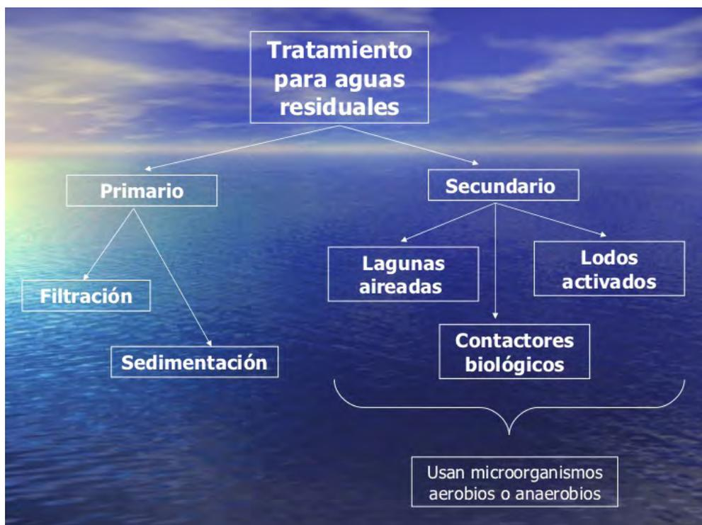
**Figura 1:** Esquema general del tratamiento de aguas residuales
