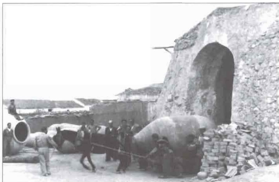
Desenhornado con «galcrilla» y la mula. Al lado de la puerta del horno están colocados los adobes de tapiar la puerta.
