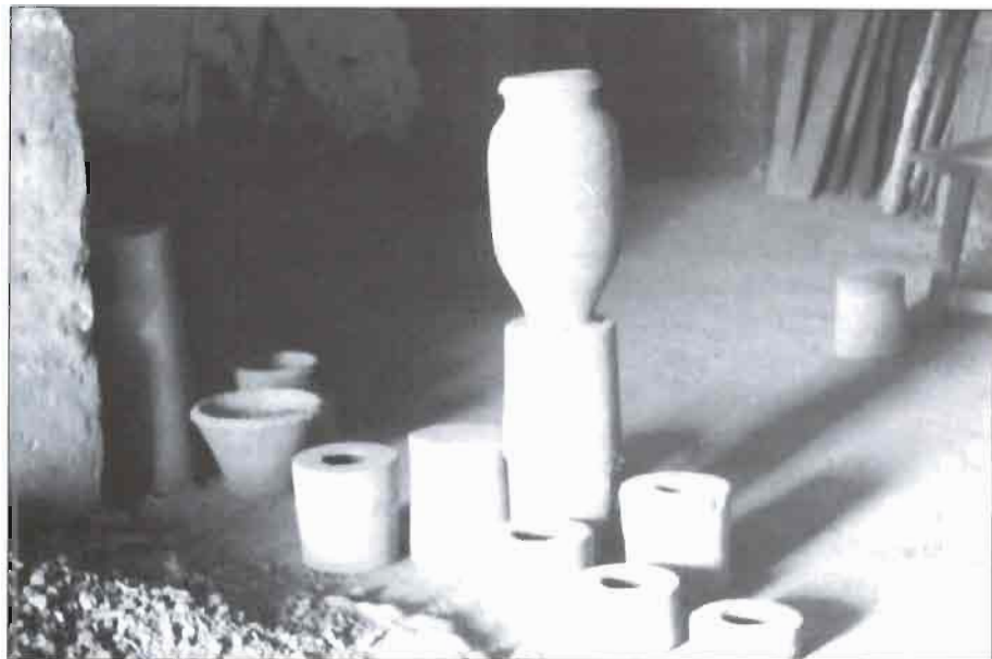
Soportes empleados en la construcción de las piezas y en su colocación en el horno: bolo, rulajas y jarrones. Fot. García Gómez.
