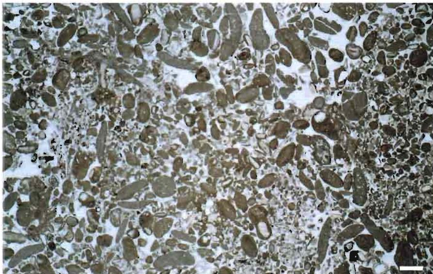
Foto 1. Grainstone bioclástico. Los bioclastos, parcialmente micritizados, son fundamentalmente de foraminíferos bentónicos y fragmentos rodados de pías y placas de equinidos. Techo de la Fm. Contreras. Escala 1 mm.
