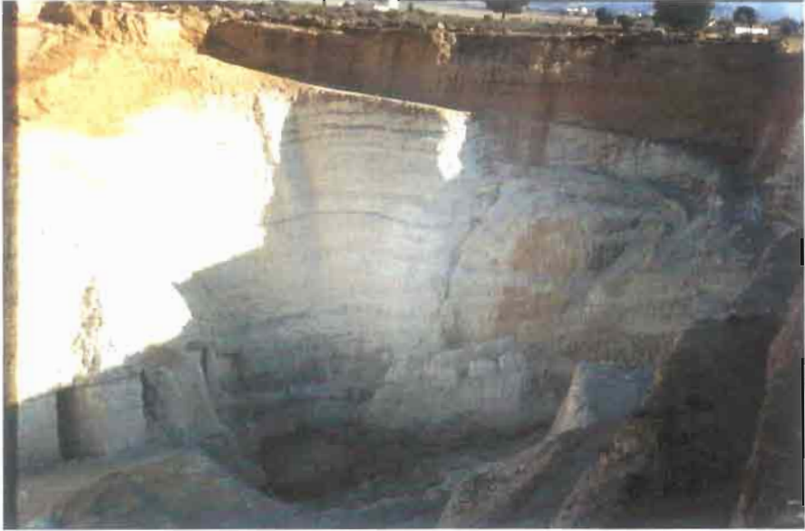
Fotografía 11.13 Explotación de diatomitas de "Alarcón Palacios" (Cuenca de Elche de la Sierra-Cobatillas) donde se pueden observar las antiguas galerías de explotación.
