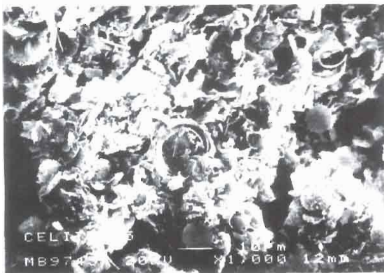
Fotografía 11.10 Imagen SEM de las margas de los "intercalarios" de la Sección "Celite", donde se observa que los restos de diatomeas aparecen rotos y corridos.
