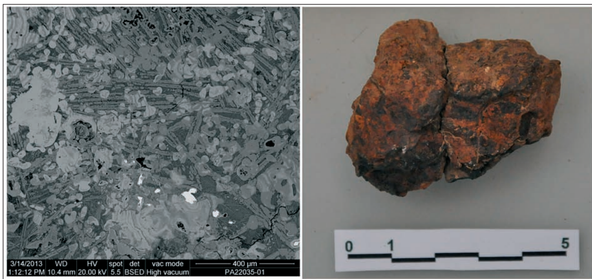
Figura 16. Detalle de la microestructura de una escoria de forja procedente de Peñarubia (Albacete). Se observan zonas de oxidación secundaria de hierro (en gris claro) con pequeños islotes de metal residual (en blanco). Imagen SEM, electrones retrodispersados. © IH-CSIC.
