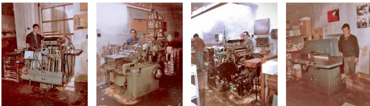
Fig. 38: De izquierda a derecha, las máquinas Grafopress, Nebiolo Plana, Automonopol y la guillotina automática Simplex, todas ellas junto a sus maquinistas respectivos citados en el texto.
