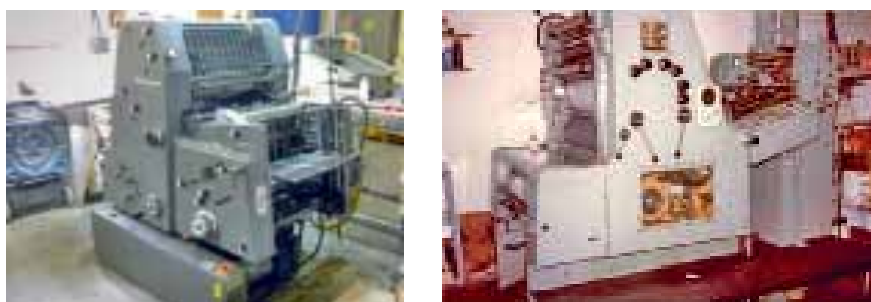
Fig. 40: De izquierda a derecha, las nuevas máquinas de impresión Offset Heidelberg GTO y Oris 9000-30-B.
