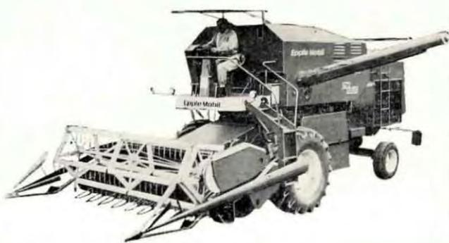
La nueva cosechadora Epple "gigante" rinde hasta 7.000 kilos por hora. Limpieza insuperable. Motor Diesel de 106 H. P. 6 cilindros. Neumáticos sobredimensionales. Facilidad de manejo. Confortabilidad. Una EPPLE que satisface todas las exigencias.
