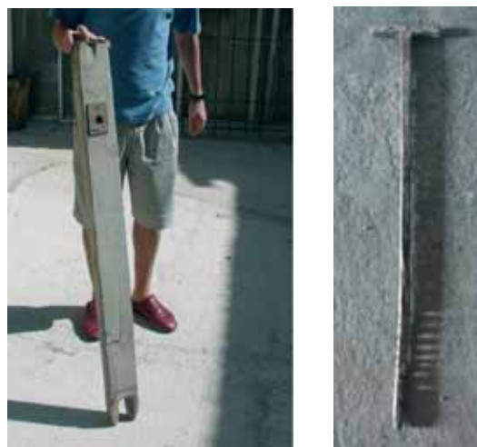
Fig 17.1 y 17.2 . Costero y aguja (Santos Cuesta, Villarrobledo). El primero con un agujero para pasar el palo de la garrucha en la parte superior y reforzado con una herradura en la inferior
