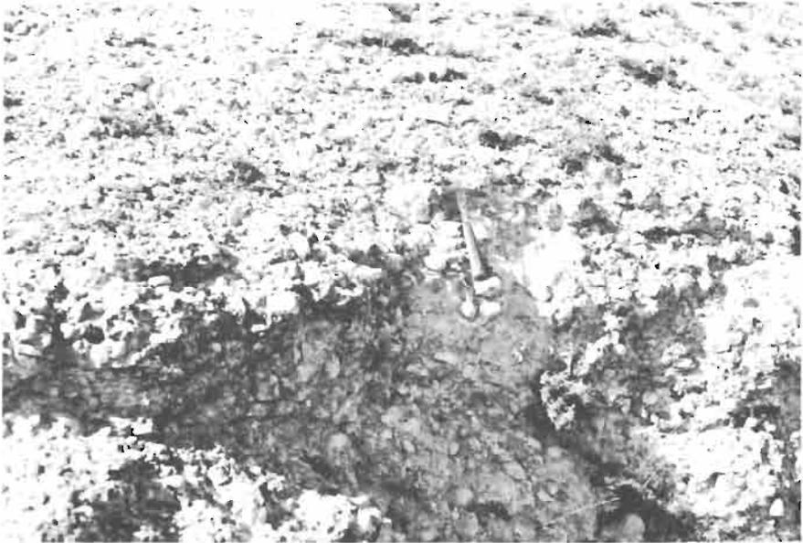
Foto 3: Conglomerado formado por cantos de cuarcita y cemento calcáreo.
