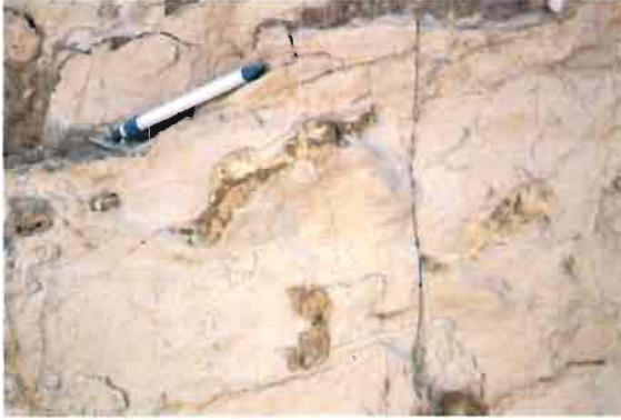
Fig. 12: Nódulos diagenéticos de azufre de morfologías irregulares, y dimensiones que llegan al decímetro. Antiguas explotaciones del Cenajo.
