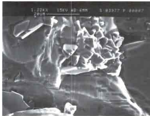
Fig. 24: Cristales idiomórficos de dolomita en el seno de azufre. Niveles estratiformes de azufre, escombreras de Las Minas de Hellín.
