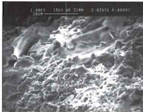
Fig. 23: Mineralización de azufre (cuerpos finamente rallados del sector superior de la foto) coexistiendo con dolomita subidiomórfica (sector inferior de la foto). Niveles estratiformes de azufre, escombreras de Las Minas de Hellín.
