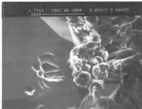
Fig. 28: Detalle de la fotografía de la fig. 24. Nótese la existencia de cristales de dolomita (dcha.) entre el cristal de celestina (izda.) y el azufre (inferior dcha.).
