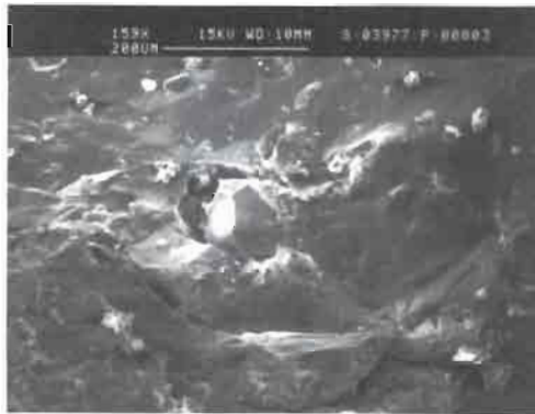
Fig. 27: Cristal idiomórfico de celestina (centro) englobado en el seno de azufre. Alternancias milimétricas de yeso y azufre, escombreras de Las Minas de Hellín.
