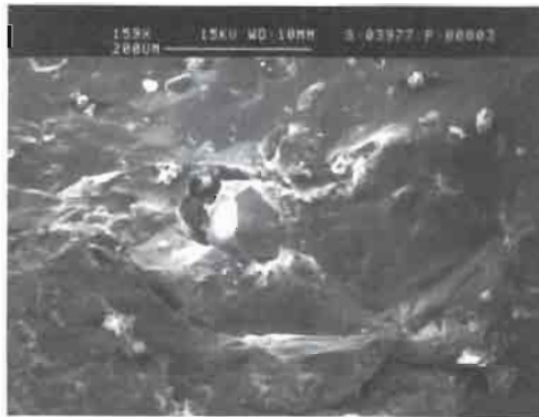
Fig. 27: Cristal idiomórfico de celestina (centro) englobado en el seno de azufre. Alternancias milimétricas de yeso y azufre, escombreras de Las Minas de Hellin.
