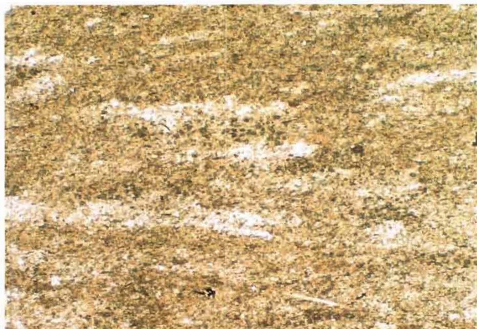
Fig. 39: Textura finamente laminada en diatomitas. Luz paralela, microscopio óptico. Cantera de Alarcón Palacios en Venta del Juez, niveles inferiores.
