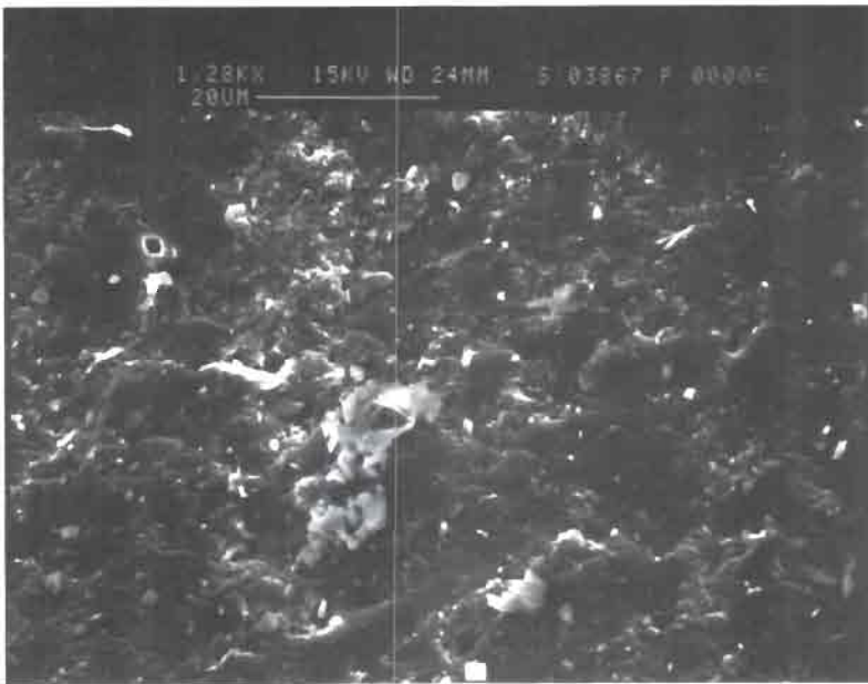
Fig. 41: Microestructura masiva constituida por ópalo C-T, y cristalitas de carbonato y silicato aislados. Nivel inferior de porcelanita aflorante en las explotaciones de Minas del Volcán en las proximidades del pantano de Camarillas. Imagen de Microscopía Electrónica de Barrido.
