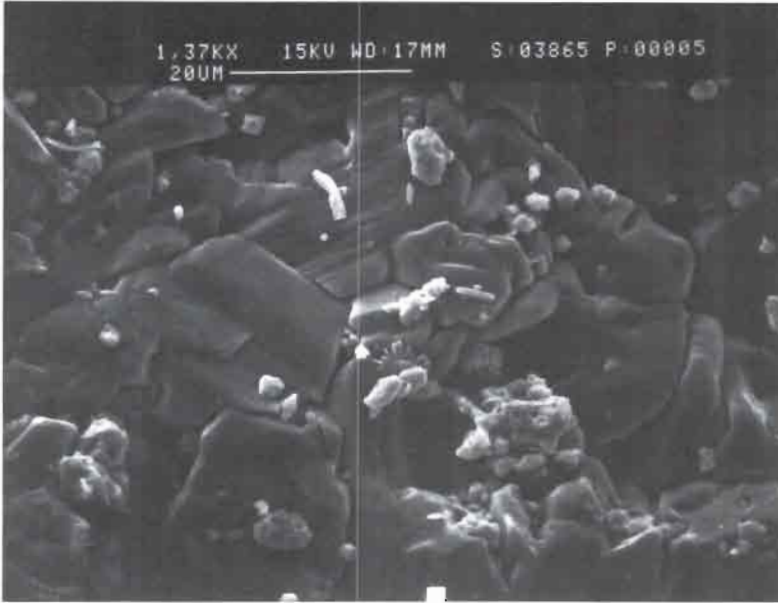
Fig. -14: Microestructura constituida por un agregado de cristales de calcita que reemplaza total o parcialmente los niveles diatomíficos. Nótese la existencia de una frústula muy disuelta en el sector central de la fotografía. Niveles infrayacentes a la porcelanita inferior aflorante en las explotaciones de Minas del Volcán en las proximidades del pantano de Camarillas. Imagen de Microscopía Electrónica de Barrido.
